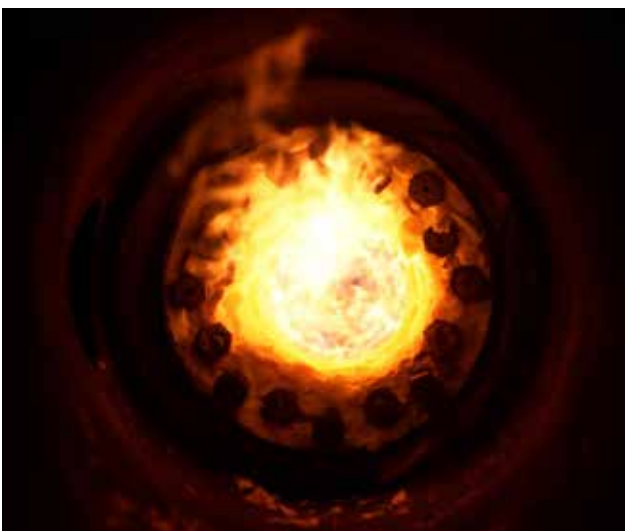
ABB. 42: GREENNH 3 -KESSELBRENNER, BETRIEB MIT AMMONIAK BEI 300 kW
