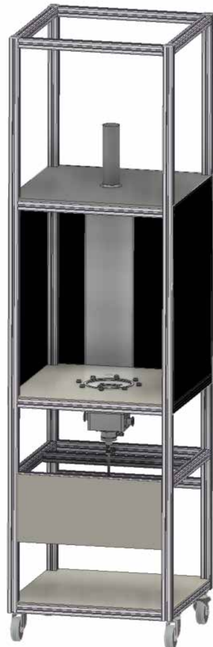
ABB. 40: VERSUCHSSTAND MIT INTEGRIERTER MIKROWELLENPLASMAQUELLE
