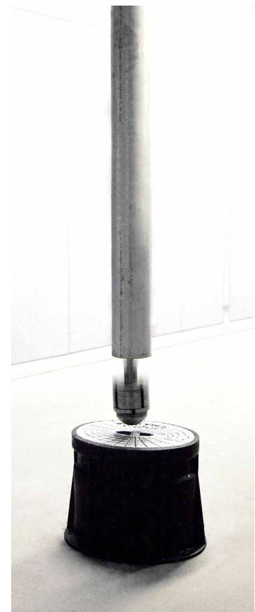
Abbildung 2: Fallversuch an Straßenkappen (Quelle: GWI, 2017)
