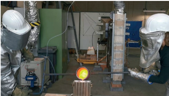
a) Abgießen flüssiger Metallschmelze
