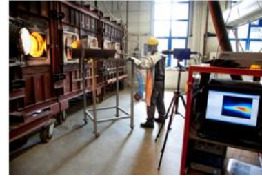
Flammvisualisierung mittels OH-Kamerasystem
