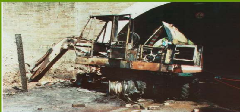
Verbrannter Löffel-Bagger nach Baggerschaden an einer HD-Leitung DN 150
