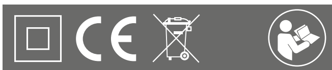
Abb. 19 Typenschild mit Symbol Schutzklasse II → Schutzisolierung
