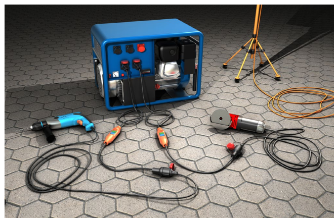
Abb. 16 Jedem Verbrauchsmittel ist eine PRCD vorgeschaltet.
